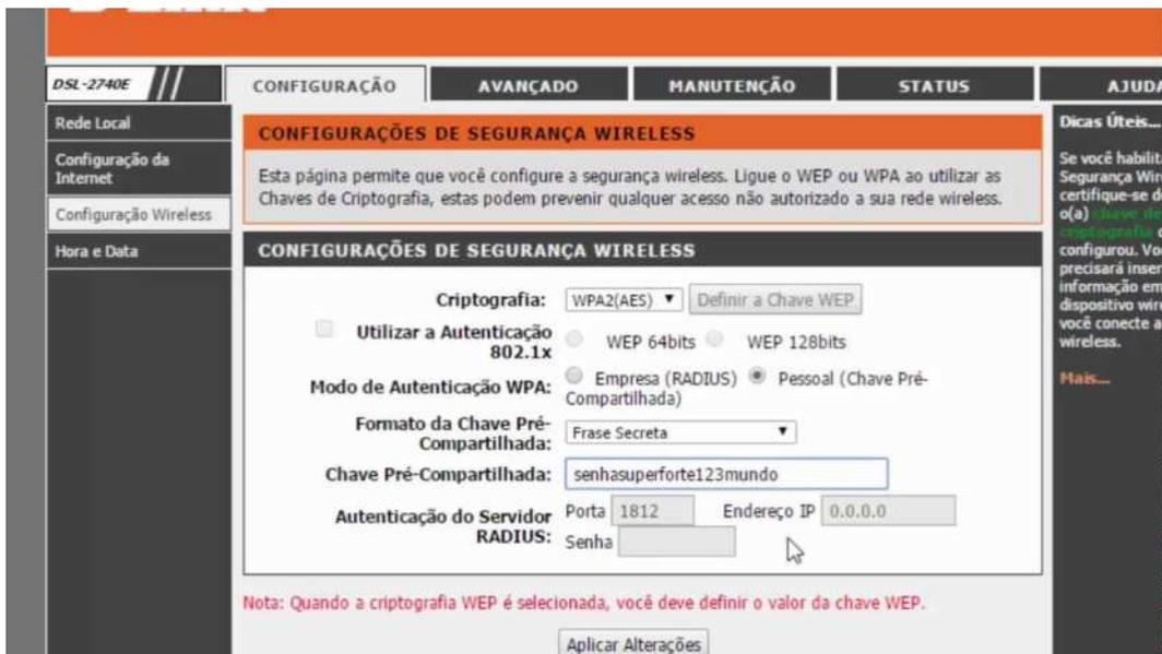
Figura 22: Cifração de uma rede sem fio pelo AES
