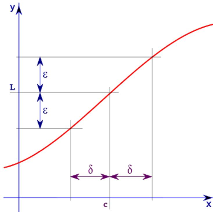
Figura 2.3.: O critério de  $\delta$  em torno de  $c$  e  $\epsilon$  em torno de  $L = f(x)$
